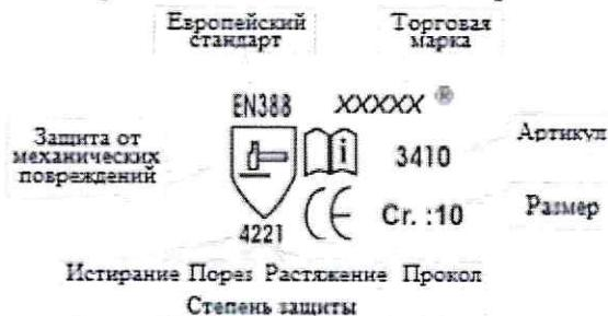
Рисунок 9.1 – Пример маркировки
